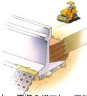
橋台、擁壁の埋戻し・裏込め
