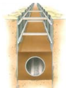
埋設管の埋戻し
