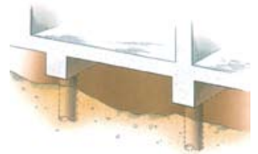
地盤沈下で生じた空洞部充填
